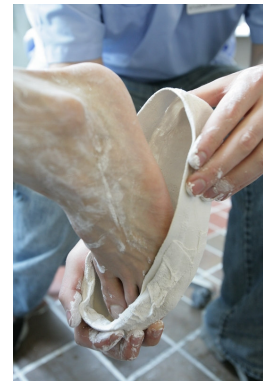
Se emplearon moldes para crear una serie de prototipos de plantillas para pruebas.
